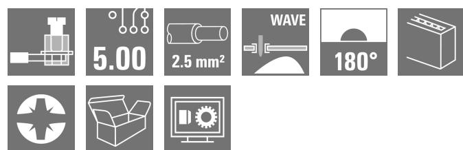
Клемма для печатной платы с проверенным на практике винтовым соединением и шагом 5,00 и 5,08 мм. Направление вывода проводов: 90°, 135° и 180°. Для проводов сечением до 2,5 мм<sup>2</sup>.
