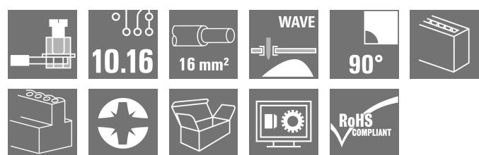
Данная клемма для печатной платы позволяет создавать соединения для тока 76 А и проводов сечением 16 мм<sup>2</sup> с проверенной на практике технологией винтового соединения с шагом 10,16 мм и направлением вывода проводов под углом 90°.
