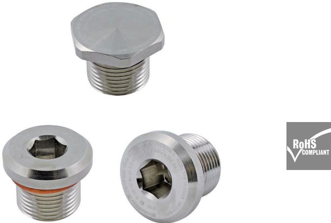
Заглушки серии VP предлагают способ заполнения неиспользуемых кабельных вводов в оборудовании, предназначенном для взрывоопасных зон, вместе с тем обеспечивая огнестойкость класса Ex d и повышенную взрывозащиту класса Ex e, а также класс защиты от проникновения загрязнений IP66/67/68.
