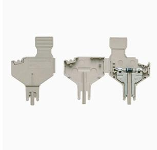
Компонентный штекер служит для интеграции электрического компонента в распепляющий клеммный блок. После пайки электронного компонента вставку можно интегрировать в распепляющую зону распепляющих клеммных блоков, тем самым преобразуя распепляющий клеммный блок в модульный клеммный блок с интегрированным электронным компонентом.
