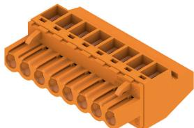
Гнездовые разъемы с соединением с зажимным хомутом для подключения проводов с направлением выводов под прямым углом (90° или 270°). Гнездовые разъемы обеспечивают место для маркировки и допускают кодирование. Крепление осуществляется с помощью фланца или фиксатора. Кроме того, они оснащены встроенным винтом с двумя шлицами (прямым и крестообразным), защищенный от неправильной вставки провода и поставляются с открытыми зажимными хомутами. HC = сильноточный.
