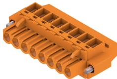
Гнездовые разъемы с соединением с зажимным хомутом для подключения проводов с направлением выводов под прямым углом (90° или 270°). Гнездовые разъемы обеспечивают место для маркировки и допускают кодирование. Крепление осуществляется с помощью фланца или фиксатора. Кроме того, они оснащены встроенным винтом с двумя шлицами (прямым и крестообразным), защищенной от неправильной вставки провода и поставляются с открытыми зажимными хомутами. HC = сильноточный.
