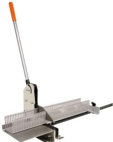
Резак кабель-каналов для ручной резки кабель-каналов и крышек шириной до 125 мм и толщиной стенки 2,5 мм. Только для пластмассы не армированной наполнителями.
