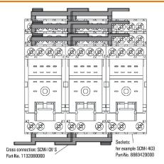
Перемычка замыкается с таким же соединением на соседнем основании
