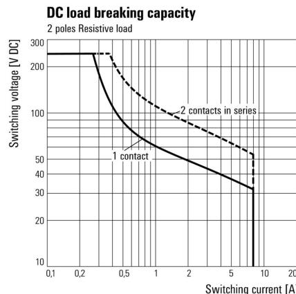
Кривая предельной нагрузки
