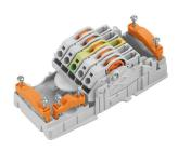
Распределение электроэнергии с использованием необработанных кабелей сечением от 1,5 до 6 мм². Подача электропитания/Т-образный отвод посредством соединения PUSH IN (0,5-10 мм²) и/или вставное соединение (0,5-4 мм²). Цветная маркировка обеспечивает четкое распределение проводов.
