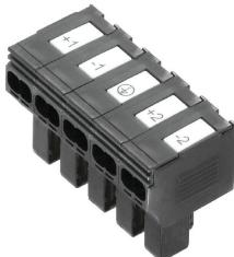
Распределение электроэнергии с использованием необработанных кабелей сечением от 1,5 до 6 мм<sup>2</sup>. Подача электропитания/T-образный отвод посредством соединения PUSH IN (0,5-10 мм<sup>2</sup>) и/или вставное соединение (0,5-4 мм<sup>2</sup>).
