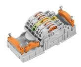
Распределение электроэнергии с использованием необработанных кабелей сечением от 1,5 до 6 мм². Подача электропитания/Т-образный отвод посредством соединения PUSH IN (0,5-10 мм²) и/или вставное соединение (0,5-4 мм²). Цветная маркировка обеспечивает четкое распределение проводов.
