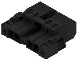
Перевернутый штекерный соединитель 180° с технологией соединения PUSH IN для проводов сечением 6 мм<sup>2</sup> с шагом 7,62 в качестве "трехфланцевого варианта" для проходного корпуса. Подходит для корпусов с макс. толщиной стенки 2 мм. Также является превосходным решением с защитой от прикосновения пальцами для обратных напряжений. Соответствует требованиям стандартов UL1059 600 V, класс C, и IEC 61800-5-1.
