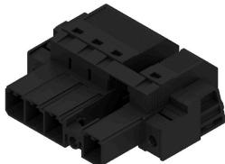
Перевернутый штекерный соединитель 180° с технологией соединения PUSH IN для проводов сечением 6 мм<sup>2</sup> с шагом 7,62 в качестве "трехфланцевого варианта" для проходного корпуса. Подходит для корпусов с макс. толщиной стенки 16 мм. Также является превосходным решением с защитой от прикосновения пальцами для обратных напряжений. Соответствует требованиям стандартов UL1059 600 V, класс C, и IEC 61800-5-1.
