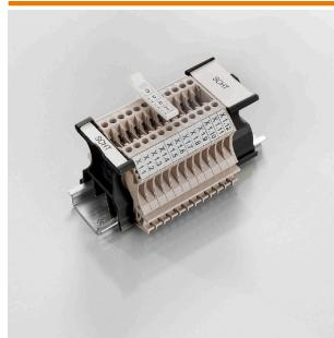
Групповые держатели шильдиков SchT 5 S крепятся непосредственно на монтажную рейку TS 32 (G-образная рейка) или TS 35 (рейка цилиндровой формы). Поэтому клеммные колодки можно маркировать вне зависимости от клемм и типа клемм. SchT 5 и SchT 5 S оснащены защитными полосами ESO 5, STR 5.
