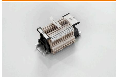
Групповые держатели шильдиков SchT 5 S крепятся непосредственно на монтажную рейку TS 32 (G-образная рейка) или TS 35 (рейка цилиндровой формы). Поэтому клеммные колодки можно маркировать вне зависимости от клемм и типа клемм. SchT 5 и SchT 5 S оснащены защитными полосками ESO 5, STR 5.
