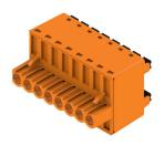
Эффективная топология типа "гирлянда" для мощных сигнальных шин подходит также для вспомогательных силовых цепей с напряжением 400 В с допустимой токовой нагрузкой 18,5 А. Большой диапазон сечений зажимаемых проводов, до 2,5 мм², вследствие малого падения напряжения обеспечивает особые преимущества при длинных шинах или сильных токах. 4 варианта фланцев, включая запатентованный фиксатор, обеспечивают блокировку, учитывающую потребности пользователя.
