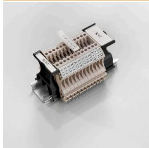
Групповые держатели шильдиков SchT 5 S крепятся непосредственно на монтажную рейку TS 32 (G-образная рейка) или TS 35 (рейка цилиндровой формы). Поэтому клеммные колодки можно маркировать вне зависимости от типа клемм. SchT 5 и SchT 5 S оснащены защитными полосками ESO 5, STR 5.
