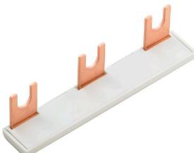
Распределение или умножение потенциала среди смежных клеммных блоков реализуется через перемычку. Это позволяет избежать дополнительных усилий при монтаже. Надежность контакта в клеммных блоках гарантирована даже при разветвлении полюсов. В нашем ассортименте представлены вставные и привинчивающиеся винтовые системы перемычек для модульных клеммных блоков.
