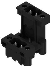
Термостойкий, двухуровневый, с боковым смещением, вилочный разъем в закрытом исполнении, фланец под пайку в качестве опции. Контактные штифты длиной 1,5 мм пригодны для пайки по технологии Reflow. Контактные штырьки длиной 3,2 мм пригодны для пайки по технологии Reflow и пайки волной. Разъемы снабжены местом для маркировки, а также они могут быть кодированы.
