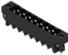
Термостойкий штекерный соединитель, упаковка — коробка или лента. На ленте и с выводами под пайку 1,5 мм оптимизирован для автоматического монтажа. Длина выводов 3,2 мм подходит для пайки волной припоя и оплавлением сквозных отверстий (Reflow). Штекерные соединители обеспечивают место для маркировки и допускают кодирование. HC = сильноточный.
