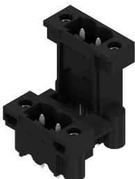
Термостойкий, двухуровневый, с боковым смещением, вилочный разъем в закрытом исполнении, фланец под пайку в качестве опции. Контактные штифты длиной 1,5 mm пригодны для пайки по технологии Reflow. Контактные штырьки длиной 3,2 mm пригодны для пайки по технологии Reflow и пайки волной. Разъемы снабжены местом для маркировки, а также они могут быть кодированы.
