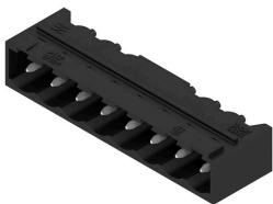
Термостойкий штекерный соединитель, упаковка — коробка или лента. На ленте и с выводами под пайку 1,5 mm оптимизирован для автоматического монтажа. Длина выводов 3,2 mm подходит для пайки волной припоя и оплавлением сквозных отверстий (Reflow). Штекерные соединители обеспечивают место для маркировки и допускают кодирование. HC = сильноточный.
