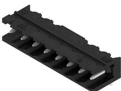
Термостойкий открытый штекерный соединитель угловой конфигурации (90°). Упаковка — коробка или лента. На ленте и с выводами под пайку 1,5 mm оптимизирован для автоматического монтажа. Длина выводов 3,2 mm подходит для пайки волной припоя и оплавлением сквозных отверстий (Reflow). Штекерные соединители обеспечивают место для маркировки и допускают кодирование. HC = сильноточный.
