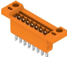
Проходной вилочный разъем для монтажа на передней панели с функцией блокировки (опция). Внутреннее соединение выполнено в виде соединения ножевого типа или под пайку. Для вилочных колодок предусмотрена возможность нанесения маркировки и кодировки.
