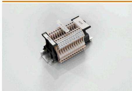
Групповые держатели шильдиков SchT 5 S крепятся непосредственно на монтажную рейку TS 32 (G-образная рейка) или TS 35 (рейка цилиндровой формы). Поэтому клеммные колодки можно маркировать вне зависимости от клемм и типа клемм. SchT 5 и SchT 5 S оснащены защитными полосками ESO 5, STR 5.
