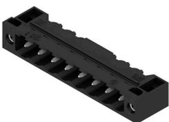
Термостойкий штекерный соединитель, упаковка — коробка или лента. На ленте и с выводами под пайку 1,5 мм оптимизирован для автоматического монтажа. Длина выводов 3,2 мм подходит для пайки волной припоя и оплавлением сквозных отверстий (Reflow). Штекерные соединители обеспечивают место для маркировки и допускают кодирование. HC = высокоточный.
