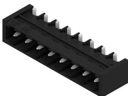
Термостойкий открытый штекерный соединитель прямой конфигурации. Упаковка — коробка или лента. На ленте и с выводами под пайку 1,5 мм оптимизирован для автоматического монтажа. Длина выводов 3,2 мм подходит для пайки волной припоя и оплавлением сквозных отверстий (Reflow). Штекерные соединители обеспечивают место для маркировки и допускают кодирование. HC = высокоточный.
