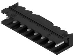
Термостойкий открытый штекерный соединитель угловой конфигурации (90°). Упаковка — коробка или лента. На ленте и с выводами под пайку 1,5 мм оптимизирован для автоматического монтажа. Длина выводов 3,2 мм подходит для пайки волной припоя и оплавлением сквозных отверстий (Reflow). Штекерные соединители обеспечивают место для маркировки и допускают кодирование. HC = высокоточный.
