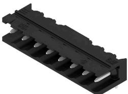
Термостойкий открытый штекерный соединитель угловой конфигурации (90°). Упаковка — коробка или лента. На ленте и с выводами под пайку 1,5 мм оптимизирован для автоматического монтажа. Длина выводов 3,2 мм подходит для пайки волной припоя и оплавлением сквозных отверстий (Reflow). Штекерные соединители обеспечивают место для маркировки и допускают кодирование. HC = сильноточный.
