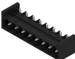
Термостойкий открытый штекерный соединитель прямой конфигурации. Упаковка — коробка или лента. На ленте и с выводами под пайку 1,5 мм оптимизирован для автоматического монтажа. Длина выводов 3,2 мм подходит для пайки волной припоя и оплавлением сквозных отверстий (Reflow). Штекерные соединители обеспечивают место для маркировки и допускают кодирование. HC = сильноточный.
