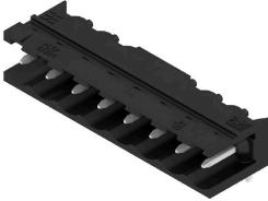
Термостойкий открытый штекерный соединитель угловой конфигурации (90°). Упаковка — коробка или лента. На ленте и с выводами под пайку 1,5 мм оптимизирован для автоматического монтажа. Длина выводов 3,2 мм подходит для пайки волной припоя и оплавлением сквозных отверстий (Reflow). Штекерные соединители обеспечивают место для маркировки и допускают кодирование. НС = сильноточный.
