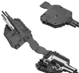
Держатель предохранителя SIHA в мгновение ока превращает клемму с размыкателем в клемму с предохранителем: просто удалите размыкающий рычажок и установите вилку предохранителя.
