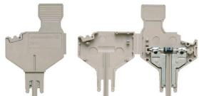
Компонентный штекер служит для интеграции электрического компонента в расцепляющий клеммный блок. После пайки электронного компонента вставку можно интегрировать в расцепляющую зону расцепляющих клеммных блоков, тем самым преобразуя расцепляющий клеммный блок в модульный клеммный блок с интегрированным электронным компонентом.
