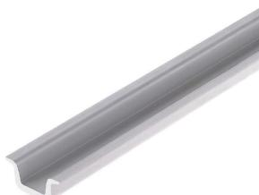
Пластиковые DIN-рейки отличаются способностью к изоляции и очень малым весом. Они могут использоваться в тех случаях, когда стандартные DIN-рейки не могут обеспечить безопасное расстояния и расстояние утечки до опорного кронштейна.
