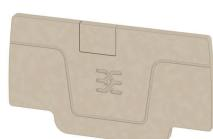
종판과 엔드 플레이트는 단자대의 필수 부속품입니다. 종판은 서로 다른 전위와 기능 그룹을 광학적으로 및 전기적으로 분리하여 안전성을 높이고 배전반 내부의 명확한 구조를 보장합니다. 엔드 플레이트는 측면의 단자대 열을 마감하고, 전류가 흐르는 부품과의 접촉을 방지하며, 깔끔하고 안정적인 마감을 보장합니다. 두 부품 모두 각각의 바이드밀러 단자대 시리즈에 정확히 대응되어 안전하고 규정을 준수하며 전문적인 배선에 기여합니다.
