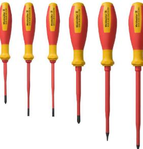
VDE 절연 스크류드라이버 세트, 최대 1000 V AC 및 1500 V DC의 전류가 흐르는 부품에서 작업 가능, DIN EN 60900, IEC 900. 각 세트 피스는 "GS" 안전 검증을 받음. 완전 강화 고합금 크로마이움-바나디움-몰리브덴 스틸 재질의 블레이드, 건 메탈 마감.
