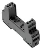
플러그형 VSPC 어레스터용 베이스 요소, 임피던스 중성 VSPC BASE의 통합된 PE 피트. 최대 20 kA(8/20 μs) 및 2.5 kA(10/350 μs)까지 안전하게 PE로 방전 가능.
