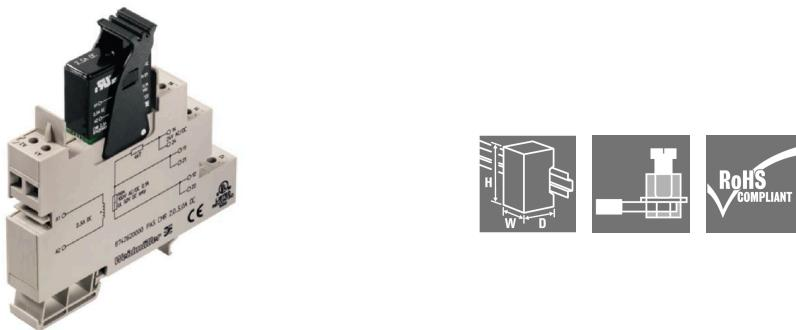
PLUGCONTROL PAS CMR은 최대 10 A의 DC 전류를 모니터링하기 위한 모니터링을 위한 간단하고 비용 효율적인 솔루션입니다. 모니터링 릴레이(REED 접점)가 표준 베이스에 장착되어 있으므로 TS35 DIN 레일에 장착할 수 있습니다. 이 모듈은 일반적으로 밸브, 서보 컨트롤 및 DC 모터의 전류 모니터링에 사용됩니다.
