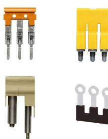
인접한 단자대에 전위를 분배 또는 증가시키는 것은 교차 연결을 통해 구현됩니다. 추가적인 결선 노력은 쉽게 피할 수 있습니다. 폴이 분리되더라도 단자대 블록의 접점 안정성은 여전히 보장됩니다. 당사의 포트폴리오는 모듈형 터미널 블록을 위한 플러그형 및 스크루형 점프바 시스템을 제공합니다.
