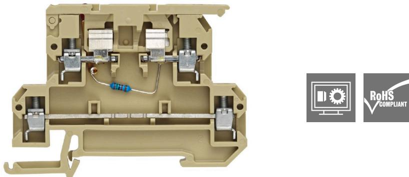
퓨즈 단자대 및 부품 단자대는 보호 및 기능 요소를 단자대에 직접 통합할 수 있게 합니다. 퓨즈 단자대는 내장형 퓨즈 홀더를 포함하여 전기 회로를 과부하로부터 안정적으로 보호하며 제어 및 분배기 레일 시스템에 이상적입니다. 부품 단자대는 다이오드, 저항기 또는 LED와 같은 전자 부품을 배선에 직접 통합할 수 있게 합니다. 이를 통해 공간 절약형이며 명확하게 배열된 스위칭 기능 및 신호 분리를 구현할 수 있습니다. 두 유형의 단자대 모두 높은 안전성, 쉬운 유지보수 및 기능 중심의 컴팩트한 설치를 보장합니다.
