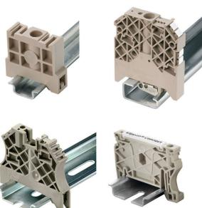
바이드뮬러 제품군에는 단자대 레일에 영구적이고 안정적으로 마운트 될 수 있도록 보장하고 미끄러짐을 방지하는 엔드 브래킷이 포함되어 있습니다. 스크류가 포함 또는 포함되지 않은 버전을 사용할 수 있습니다. 엔드 브래킷에는 마킹 옵션(그룹 마커용 포함)과 테스트 플러그 홀더가 포함되어 있습니다.
