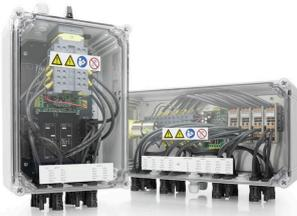
안전한 원격 종료를 위해 옥상 태양광 시스템에서 건물 내 전력망과 연결된 케이블이 건물 내부로 진입하는 지점에 단선 장치를 필요로 할 수 있습니다. 이렇게 하면 소방대가 불필요한 위험 없이 비상시 진화작업을 수행할 수 있습니다. 전원 공급 장치가 복원되면 PV Next Fireman 스위치가 자동으로 PV 스트링을 다시 연결합니다.
