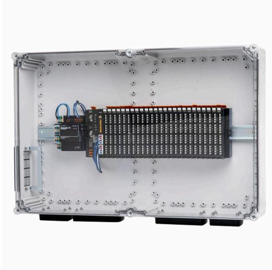
단극 차동 전압 측정용 CVM 박스는 고객 사양에 따라 조립되며 Plug & Play 솔루션을 사용하여 현장에서 빠르고 쉽게 설치할 수 있습니다. Weidmüller의 추가적인 엔지니어링 서비스는 안전하고 포괄적인 프로젝트 구현을 지원합니다. 전기 분해 스택의 수명은 수소 제조의 경제 효율에 매우 중요합니다. CVM 박스는 개별 셀의 차동 전압을 모니터링하여 시스템 효율을 높이는 데 결정적인 기여를 합니다. 데이터 분석을 통해 시스템을 감시할 수 있으며, 사용자는 언제든지 기술 상태를 확인할 수 있고, CVM 박스를 사용하여 편차를 인식하고 사전에 정비 및 유지보수를 계획할 수 있습니다.
