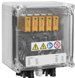
1 내지 12개의 MPP 추적기를 갖는 인버터에 대한 PV Next 접속함은 태양광 시스템의 DC 면을 보호하는 데 사용됩니다. 접속함은 인버터를 과전압으로부터 보호하고 유럽 지침 CLC/TS 51643-32를 준수합니다. 또한, 이러한 제품은 시스템을 역류로부터 보호할 가능성과 설치 도중 케이블을 절약할 수 있도록 스트링을 결합시킬 수 있는 가능성을 제공합니다.
