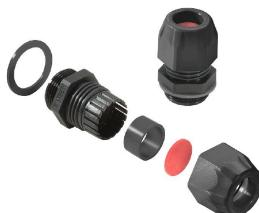
폴리아미드 케이블 글랜드는 폭발 위험 영역 Ex e (향상된 안전) 및 Ex i (본질 안전)에서 사용하기 적합합니다. 바이드뮬러는 제한 없이 제품군을 제공하며 표준 준수 외에도 케이블 글랜드는 4/7 솔의 향상된 충격 내성 및 제한 없이 -60°C까지 견딜 수 있는 폭넓은 온도 범위를 자랑합니다. 바이드뮬러 제품은 현행 기준 및 EN 60079-0 지침에 따른 시험을 거쳤으며, ATEX와 IECEEx 인증도 획득했습니다.
