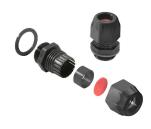
폴리아미드 케이블 글랜드는 폭발 위험 영역 Ex e (향상된 안전) 및 Ex i (본질 안전)에서 사용하기 적합합니다. 바이드뮬러는 제한 없이 제품군을 제공하며 표준 준수 외에도 케이블 글랜드는 4/7 줄의 향상된 충격 내성 및 제한 없이 -60°C까지 견딜 수 있는 폭넓은 온도 범위를 자랑합니다. 바이드뮬러 제품은 현행 기준 및 EN 60079-0 지침에 따른 시험을 거쳤으며, ATEX와 IECEx 인증도 획득했습니다.
