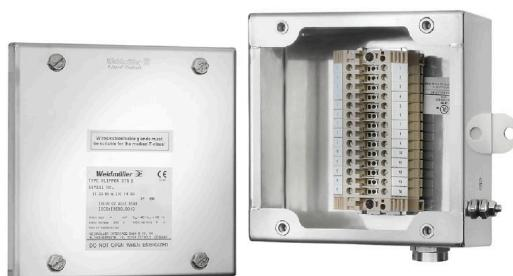
폭발 위험 구역 내 신호 / 전력 공급 장치 또는 분배기 설치에 사용되는 다양한 유형의 단자함이 있습니다. 터미널 박스는 0, 1, 2 및 20, 21, 22 구역의 Ex 지역에서 사용하도록 승인된 폭발 방지 장비입니다. 최신 국제 표준 Ex e, Ex ia 및 Ex tb 적합 장비로 인증을 획득했습니다. 이 단자함 제품들은 고객별로 구성되기 때문에 모든 응용 부문에 가장 적합한 솔루션입니다. 제품 개요를 이용해 필요한 용도에 맞는 솔루션을 찾아보세요! 스레드 구멍이 있거나 없는 인클로저, 적합한 장착 레일 또는 사전 맞춤 스트립 단자대 조합을 선택해 보세요. 몇 가지 제품 구성이 준비되어 있으며, 맞춤 솔루션도 정성껏 준비해 드립니다.
