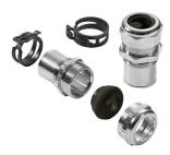
전자 콤포넌트의 감도가 높아지고 전자기 간섭 주파수가 늘어남에 따라 케이블 글랜드는 시스템의 차펴 측면에서 중요한 역할을 하고 있습니다. 이러한 유형의 EMC 케이블 글랜드는 360° 스크리닝 결선을 이용해 간섭 주파수로부터 차펴 기능을 발휘하도록 제작되었습니다. 핑거 록킹 씰이탁월한 케이블 유지 및 스트레인 릴리프 기능을 제공하며, 그 옆의 케이블 글랜드는 EN 62444의 기계적 요구 사항을 충족합니다. 특허 받은 설계로 매우 간편하고 신속한 조립이 가능합니다.
