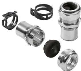
전자 콤포넌트의 감도가 높아지고 전자기 간섭 주파수가 들어남에 따라 케이블 글랜드는 시스템의 차폐 측면에서 중요한 역할을 하고 있습니다. 이러한 유형의 EMC 케이블 글랜드는 360° 스크리닝 결선을 이용해 간섭 주파수로부터 차폐 기능을 발휘하도록 제작되었습니다. 핑거 록킹 씰이 탁월한 케이블 유지 및 스트레인 릴리프 기능을 제공하며, 그 옆의 케이블 글랜드는 EN 62444의 기계적 요구 사항을 충족합니다. 특히 받은 설계로 매우 간편하고 신속한 조립이 가능합니다.
