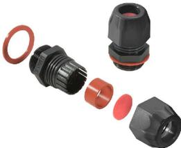
폴리아미드 케이블 글랜드는 폭발 위험 영역 Ex e (향상된 안전) 및 Ex i (본질 안전)에서 사용하기 적합합니다. 바이드물러는 제한 없이 제품군을 제공하며 표준 준수 외에도 케이블 글랜드는 4/7 줄의 향상된 충격 내성 및 제한 없이 -60°C까지 견딜 수 있는 폭넓은 온도 범위를 자랑합니다. 바이드물러 제품은 현행 기준 및 EN 60079-0 지침에 따른 시험을 거쳤으며, ATEX와 IECEx 인증도 획득했습니다.
