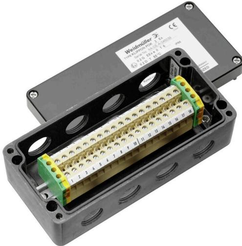
폭발 위험 구역 내 신호 / 전력 공급 장치 또는 분배기 설치에 사용되는 다양한 유형의 단자함이 있습니다. 터미널 박스는 0, 1, 2 및 20, 21, 22 구역의 Ex 지역에서 사용하도록 승인된 폭발 방지 장비입니다. 최신 국제 표준 Ex e, Ex ia 및 Ex tb 적합 장비로 인증을 획득했습니다. 이 단자함 제품들은 고객별로 구성되기 때문에 모든 응용 부문에 가장 적합한 솔루션입니다. 제품 개요를 이용해 필요한 용도에 맞는 솔루션을 찾아보세요! 스레드 구멍이 있거나 없는 인클로저, 적합한 장착 레일 또는 사전 맞춤 스트립 단자대 조합을 선택해 보세요. 몇 가지 제품 구성이 준비되어 있으며, 맞춤 솔루션도 정성껏 준비해 드립니다.
