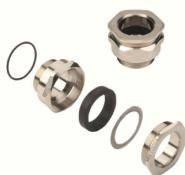
KSG는 피복이 없는 케이블과 라인의 결선용으로만 사용됩니다. 케이블 글랜드와 함께 네오프렌 실을 주문했다면 -35°C ~ +90°C의 온도 범위에서 이 실을 사용할 수 있습니다. 실리콘 실을 사용하는 경우에는 -60°C ~ +180°C의 온도 범위가 가능합니다. 제공 품목에 포함된 O-링과 케이블 글랜드는 같은 재질로 만들어져 있습니다. 이 실링을 사용하는 경우 수중 25 m 깊이(2.5 bar의 압력)에서 IP66 또는 IP68 보호가 보장됩니다. KSG는 내압 방폭(Ex d) 밀봉 및 안전증 방폭(Ex e) 구조에서 사용하도록 허가되었습니다.
