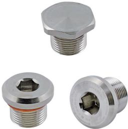
VP 시리즈 방폭 플러그는 Ex 장비에서 미사용 입력부를 채우는 용도로 사용되며, 내염(Flameproof) Ex d 및 안전성 강화(Increased Safety) Ex e 방폭 및 IP66/67/68 진입율을 유지합니다.
