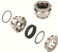
KSG는 피복이 없는 케이블과 라인의 결선용으로만 사용됩니다. 케이블 글랜드와 함께 네오프렌 실을 주문했다면 -35°C ~ +90°C의 온도 범위에서 이 실을 사용할 수 있습니다. 실리콘 실을 사용하는 경우에는 -60°C ~ +180°C의 온도 범위가 가능합니다. 제공 품목에 포함된 O-링과 케이블 글랜드는 같은 재질로 만들어져 있습니다. 이 실링을 사용하는 경우 수중 25 m 깊이(2.5 bar의 압력)에서 IP66 또는 IP68 보호가 보장됩니다. KSG는 내압 방폭(Ex d) 밀봉 및 안전증 방폭(Ex e) 구조에서 사용하도록 허가되었습니다.
