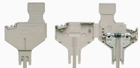
콤포넌트 플러그는 분리 단자대 블록에 전기 콤포넌트를 통합하는 데 사용됩니다. 전자 콤포넌트를 납땜한 후 플러그를 분리 단자대 블록의 분리 영역에 통합할 수 있으므로 분리 단자대 블록을 전자 부품이 통합된 모듈식 단자대로 변경합니다.
